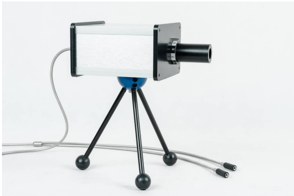
Rys. 2 Teleskop – przystawka do pomiaru luminancji energetycznej podłączana do spektrometru za pomocą światłowodu
